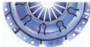
Si bien la placa de embrague sufre su mayor desgaste en la zona de fricción con el disco, existe un punto que también es sensible al uso y las vibraciones del motor. Allí donde los anillos de basculación rozan con el disco, es posible que se produzca un
